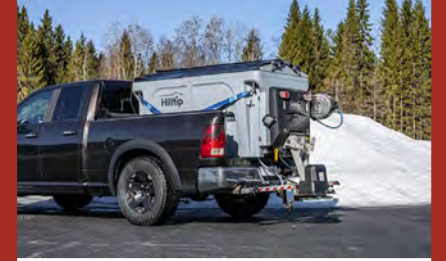
Hilltip Icestriker 900–1600L Salt og sanddreifari í tveimur stærðum fyrir stóra pallbíl og minni vörubíla. Rafdrifinn 12V.
