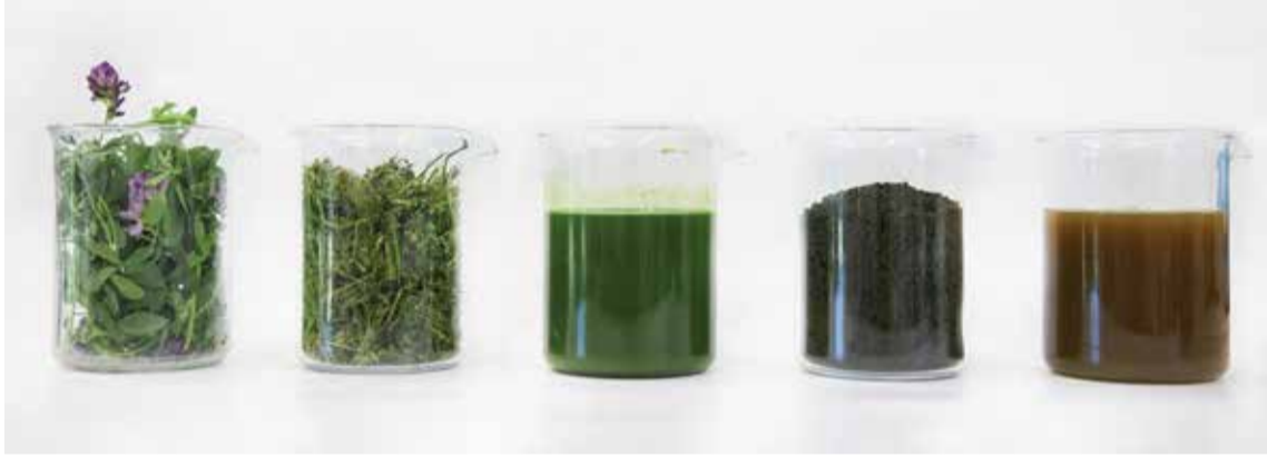
Myndin sýnir upprunalegan efniðvið (refasmára) og afurðir úr vinnslunni sem eru trefjarnar, grænn safi, próteinið, fyrir þurrkun, og brúnn safi.
