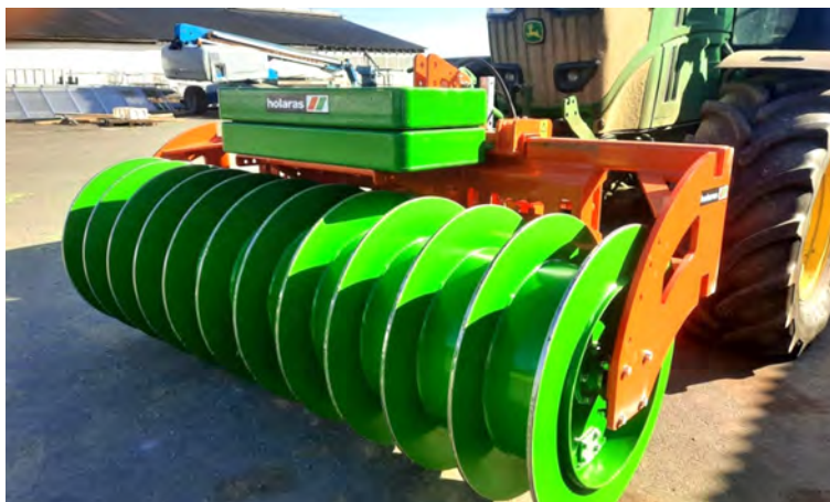
Mynd 2. Stæðuvalti framan á dráttarvél. Hér væri t.d. hægt að vera með pinnatætara aftan á vélinni.
