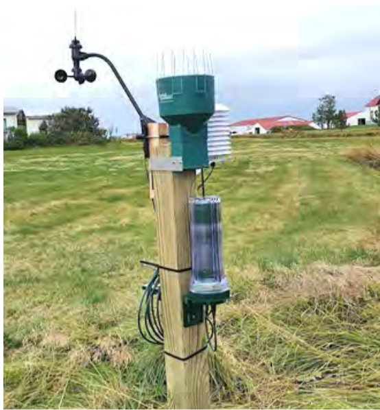
Sjálfvirk sólardrifin veðurstöð í Þykkvabæ til mælinga á mygluhættu.
